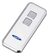
Handzender Mini-Novotron 522 Design Tweekanaals, 433 MHz, KeeLoq-Wisselcode
