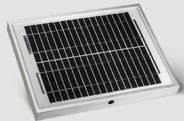
Zonnepaneel Vermogen Pmax 10 Wp, Open circuit voltage 21.5 V, Stroom bij Pmax 0,5 A, Afmetingen 370 x 310 mm • Alleen toepasbaar op: Novomatic 423 Accu
