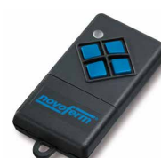
Handzender Mini-Novotron 404 Multibit, vierkanaals, 433 MHz
