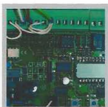
Digitale besturing, met LCD display Centrale de commande digitale avec LCD
